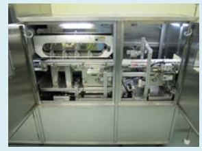
定ピッチ切出し部
